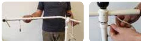
4. Posizionare il contrappeso nel retro del braccio orizzontale tramite la rotazione dello stesso in senso orario. È importante che il contrappeso venga fissato in maniera stabile sul braccio!
