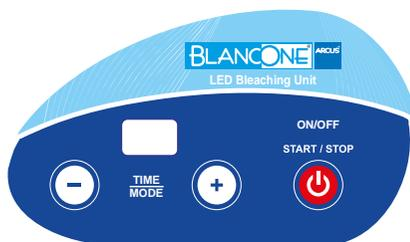
6. Se uno qualsiasi dei pulsanti TIMER / MODE (+ / -) viene premuto durante il funzionamento, il dispositivo entrerà in modalità Pausa. Il display lampeggiante con il tempo rimanente indica che il dispositivo è in pausa. Il funzionamento riprenderà premendo nuovamente il pulsante TIMER / MODE (+ / -).
